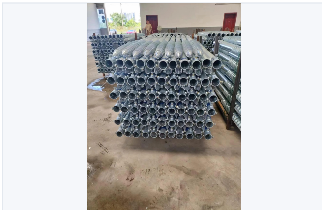
Feuerverzinkte und verpackte Schraubfundamente – Endkontrolle vor dem Versand.
