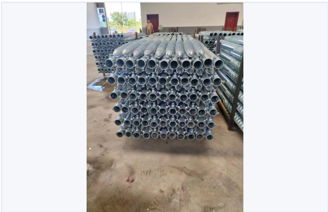
热镀锌完成并打包好的地桩——发货前的终检。
