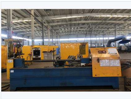
半自动钢带焊接机——焊接螺纹钢带。
